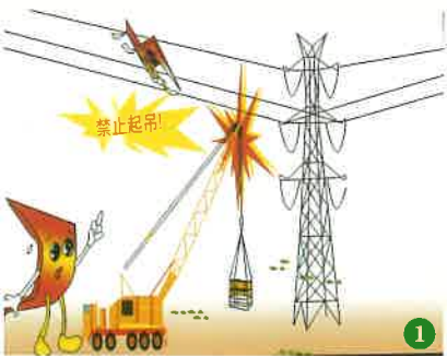
1 高压线下禁止起吊违章作业。
